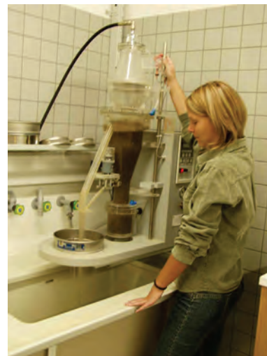
Bodenextraktion nach Fenwick mit dem MEKU-Bodenprobenextraktor
